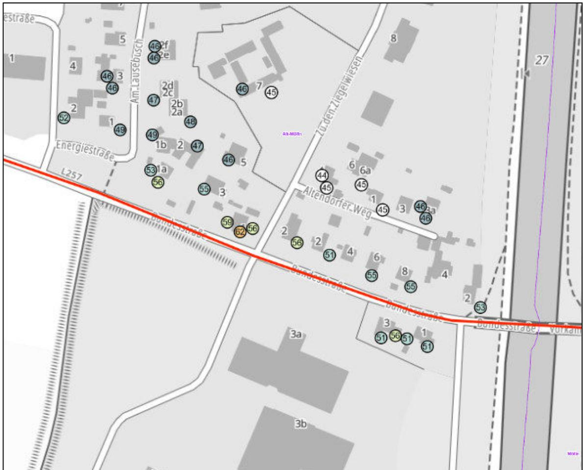
Grundsätzlich stellen die ermittelten Lärmpegel entsprechend den Vorgaben für den Straßenverkehr A-bewertete äquivalente Dauerschallpegel (Mittelungspegel) dar. Der Mittelungspegel wird bei zeitlich schwankenden Geräuschsituationen verwendet. Einzelereignisse wie z.B. einzelne laute Fahrzeuge können durchaus lautere Pegel erzeugen. Solche Einzelereignisse werden überproportional im Mittelungspegel berücksichtigt.
